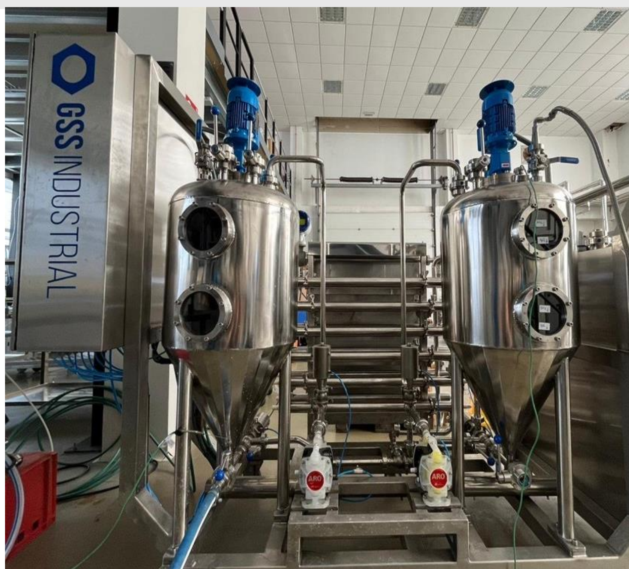
Prototipo de tratamiento de productos líquidos por la tecnología de UV
